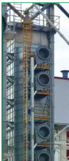
Система горизонтальных циклонов предназначена для осаждения легкого мусора, выносимого из вентиляторов зерносушилки. По инерции мусор выносит в вертикальный самотек, далее вниз к бункеру отходов. Таким образом, из зерносушилки наружу выходит очищенный воздух. Эффективность освобождения от легких примесей при этом составляет 95%, что позволяет эксплуатировать зерносушилки серии Vesta даже в черте города.
