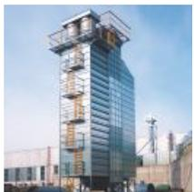
Зерносушилка Vesta-ECO экономична по удельным расходам топлива, электроэнергии и удельной металлоёмкости. Для повышения КПД в зоне охлаждения применена технология рекуперации воздуха. Кроме того, в Veste используются полимерные материалы и щадящий режим сушки, а значит хозяйство получает зерно хорошего качества с высокой рыночной стоимостью.
