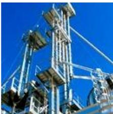
Нории зерновые ленточные ковшовые (ковшовые элеваторы) необходимы для обеспечения вертикального перемещения зерна и продуктов его переработки. Активное применение данного оборудования происходит на мукомольных и комбикормовых предприятиях, на элеваторах, сушильно-очистительных башнях, хлебоприемных пунктах.
