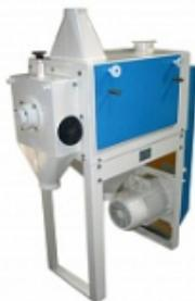
Обоечная машина БОС предназначена для **обработки верхнего покрова зерна** на мукомольных заводах. Технологический процесс при сортовых помолах предусматривает не менее двух пропусков (проходов) зерна через эти машины.
